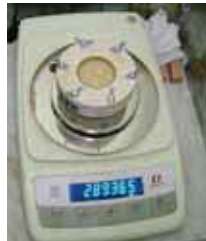
Bacinelle e campione per la prova di permeabilità al vapore
