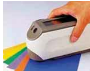
Prova colorimetrica con spettrofotografo portatile
