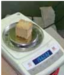
Bacinelle e campione per la prova di peso di volume
