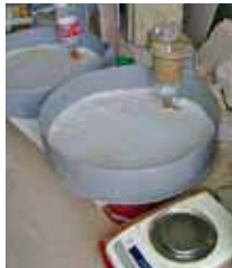
Bacinelle e bilancia per la prova di capillarità
