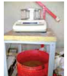
Bilancia su supporto e recipiente con acqua deionizzata
