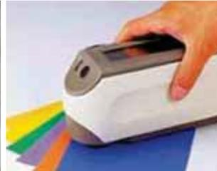
Prova colorimetrica con spettrofotografo portatile
